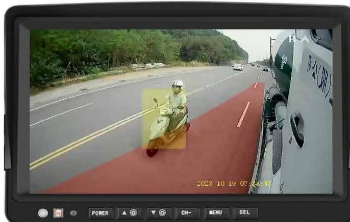
透過車內螢幕可見偵測區塊，將鏡頭角度調整至**警示區塊需與車身貼齊** (如圖)，偵測區塊尾端角度需調整至車尾處。
