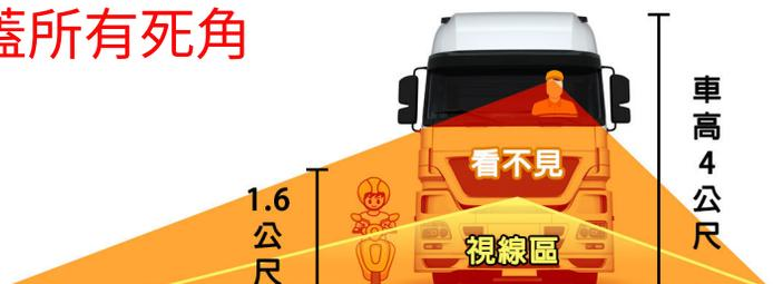
針對該問題，本產品透過原車行車視野輔助系統加裝AI盲區影像辨識系統控制盒即可使原鏡頭有辨識功能，駕駛人能透過螢幕知覺性的察看偵測對象，系統不限安裝方向，皆可自動偵測辨識，駕駛人於行車時，按不同的車速及條件對盲區進行偵測。系統可透過視覺和聲音警示進行主動預警，提醒駕駛人注意盲區偵測區域內有偵測物進入，進而保護乘客及用路人的安全。
