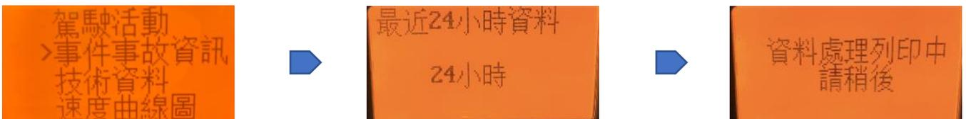
在列印功能選單下，選擇事件事故資訊可使內建列印機於熱感紙上列印所產生之超速、怠速等事件，可以選擇最近1~24小時的時間區段。
