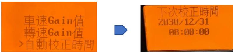
在系統參數選單下，選擇車速相關設定之自動校正時間，將顯示下次自動校正日期及時間。
