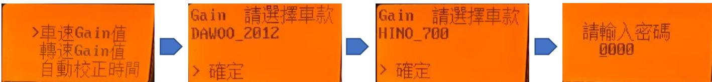
在系統參數選單下，選擇車速相關設定之車速 Gain 值，可以依照車型車款設定相對應的車速 Gain 值，需輸入 VDR 密碼以完成設定。
